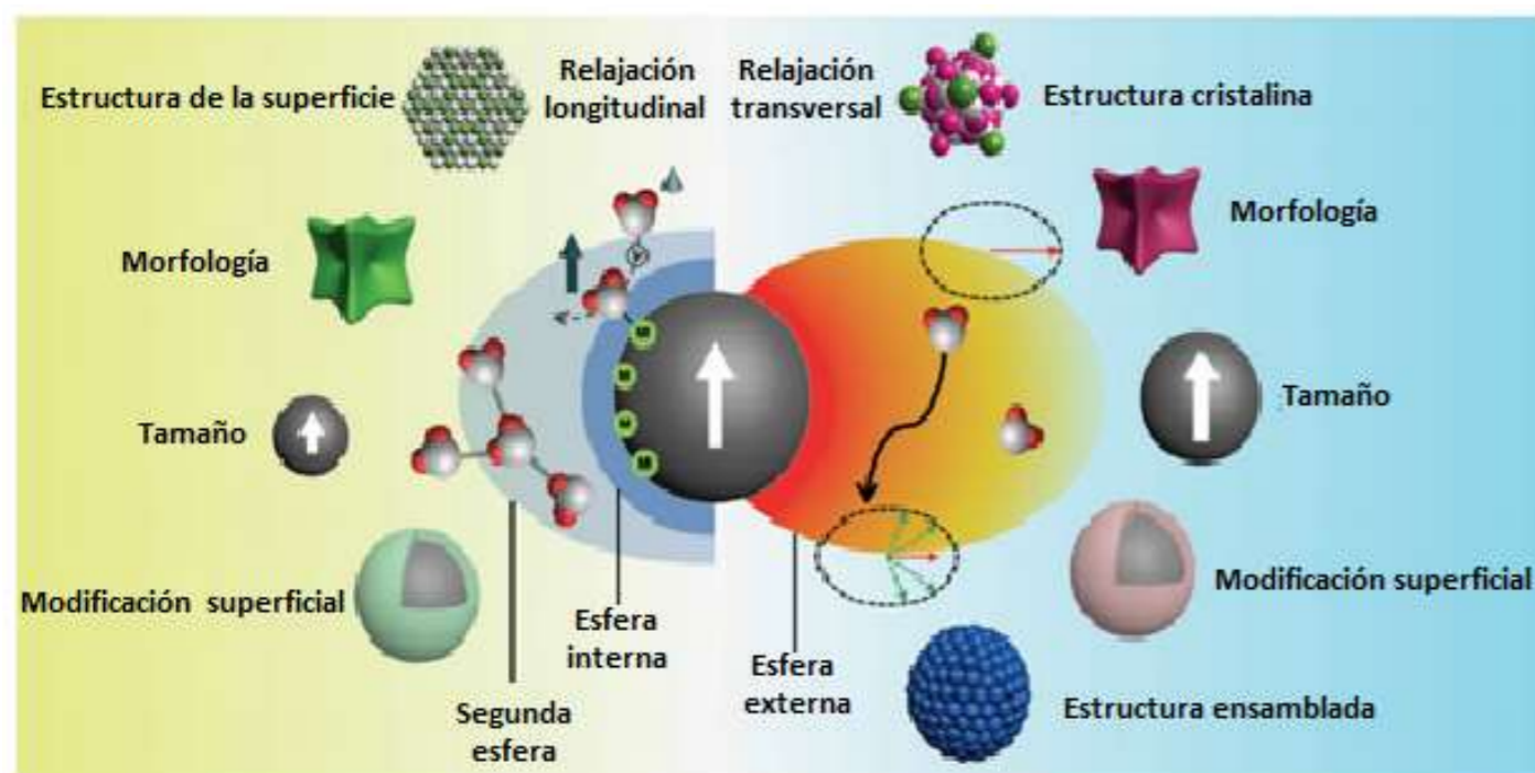
Figura 2. Diagrama esquemático de nanopartículas magnéticas que interactúan con moléculas de agua mediante los mecanismos de esfera interna y externa, destacándose las diferentes características estructurales que permiten mejorar la relajación R1 y R2
