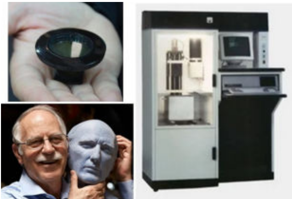
Figura 1. Primer objeto obtenido mediante impresión 3D (1983), creador del método Charles "Chuck" W. Hull y primera impresora de estereolitografía SLA-1.
