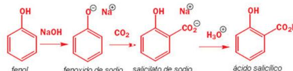
**Figura 12.** Método usado por Koble para la obtención del ácido salicílico.
