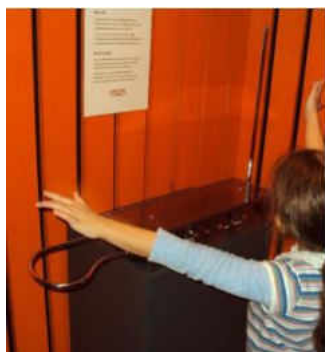
Figura 1. El “Theremin”: La física al servicio de la música. Este instrumento, concebido por el físico y músico soviético Lev Segueevich Termen en 1919, logra sonidos musicales derivados del efecto capacitivo del cuerpo humano sobre ondas electromagnéticas. En la foto, un ejemplar del instrumento que se expone en el Museo Nacional Noruego de Ciencia y Tecnología (foto: E. Altshuler).
