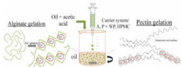
Figura 6. Representación esquemática de la formación de microesferas por gelación interna de NaAlg con cationes \text{Ca}^{2+} . 9
