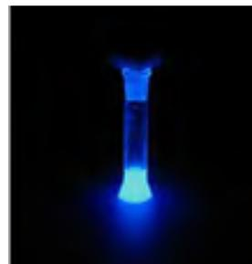
**Figura 2.** Luminiscencia provocada por el Luminol en contacto con sangre
