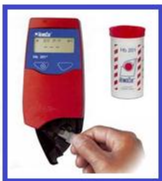
Fig. 2. Imagen de un glucómetro óptico comercial. En la parte derecha aparece una tira que contiene la microcubeta (círculo rojo central).
